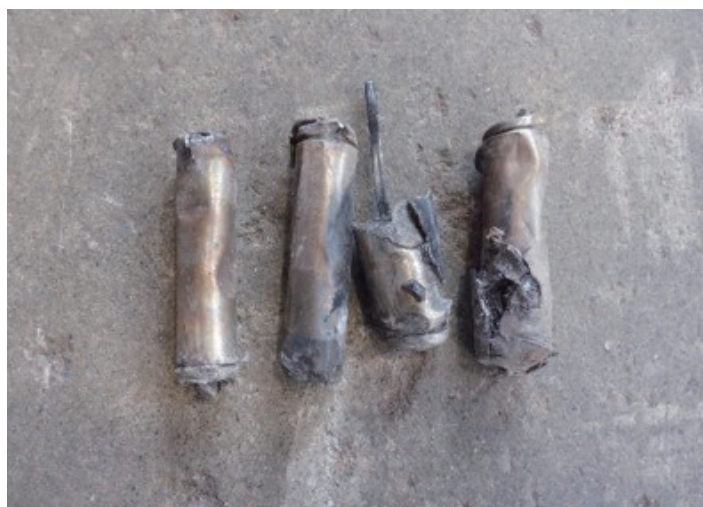
火事の原因になった可能性のある電池
